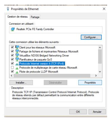
Puis remplissez les champs Adresse ip avec une adresse sur le réseau 192.168.3.0, un masque de sous réseau en 255.255.255.0 et mettre en passerelle, l'adresse ip de l'interface eth2.
