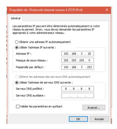
Faire la même chose pour l'ordinateur sur le réseau de l'interface eth1, et mettre en passerelle l'adresse de l'interface eth1
